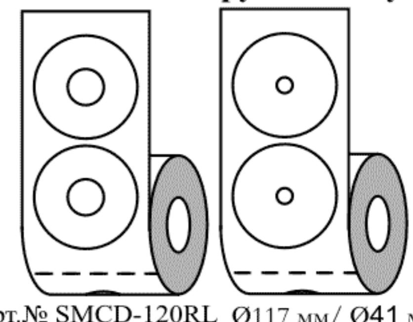
Арт.№ SMCD-120RL Ø117 мм / Ø41 мм
